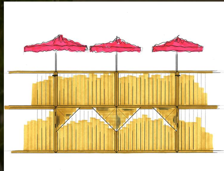
Der 2m hohe Zaun ist aus Lärche gefertigt. Eine mit Holzplatten versehene Rahmenkonstruktion sorgt für eine hohe Beständigkeit.
