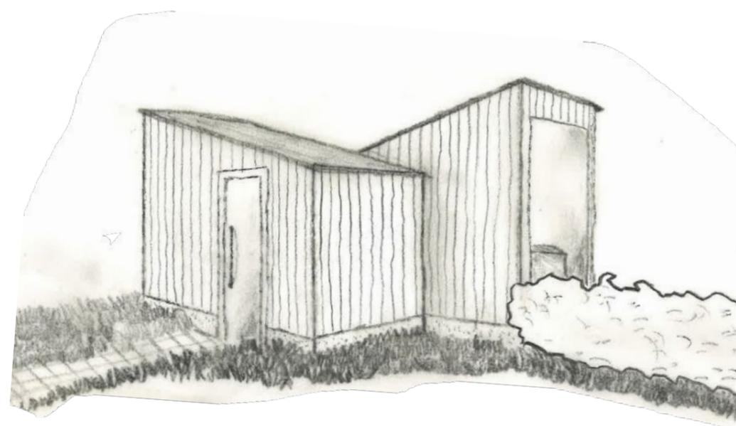
Die FitWellHut ist ein reiner Holzbau, gefertigt mit einer Holzriegelkonstruktion. Die Zwischenräume zwischen den einzelnen Holzelementen mit Dämmwolle gefüllt. Zur Stabilisation beitragend, sind sowohl auf der Innen- als auch auf der Außenseite OSB-Platten angebracht. Das Bauwerk hat eine hinterlüftete Fassade ebenfalls aus Holz.
