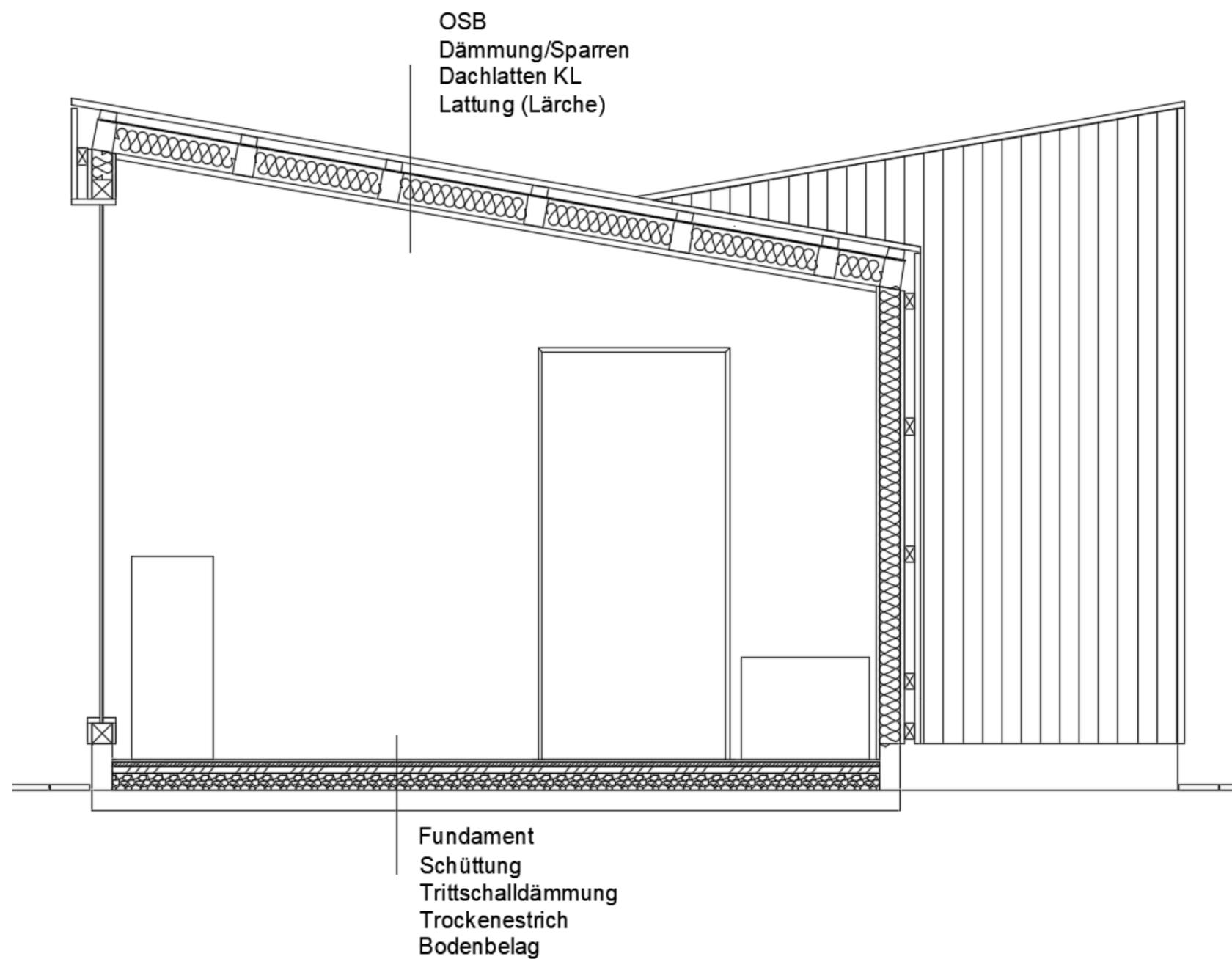
Abbildung 4: CAD Zeichnung-Schnitt
