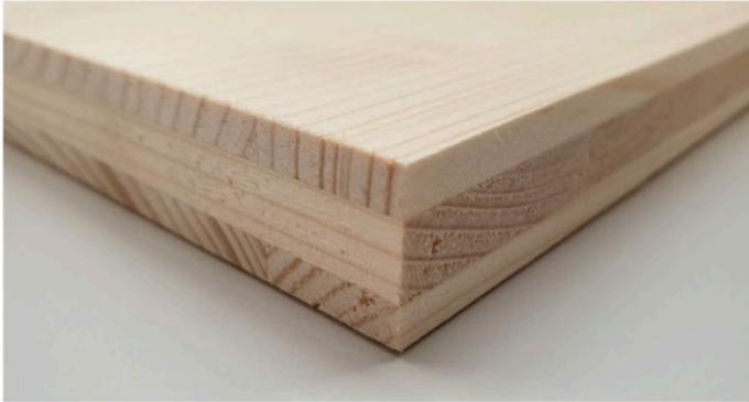
Der untere Korpus besteht aus Fichte Dreischichtplatten. Sie werden mit Lamello (Flachdübel) verbunden.
